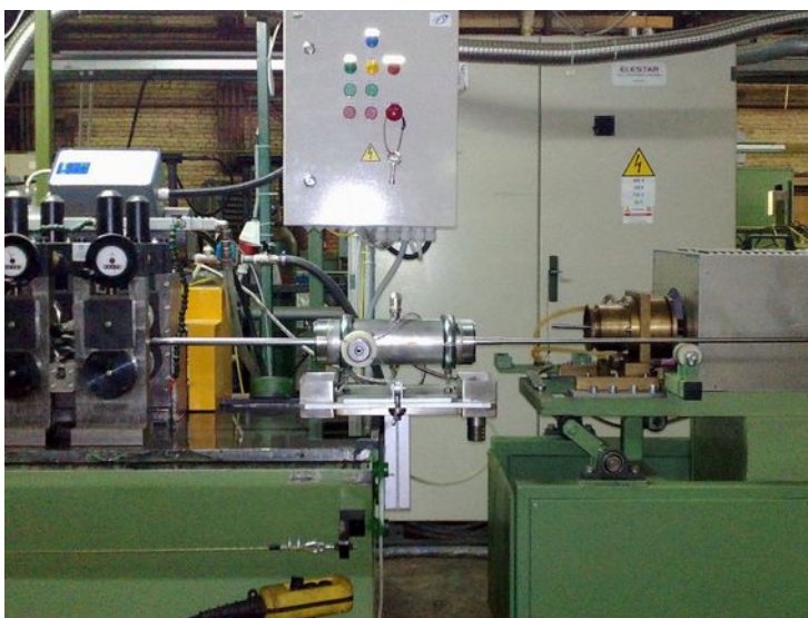
← Встраиваемый модуль для очистки поверхности труб
