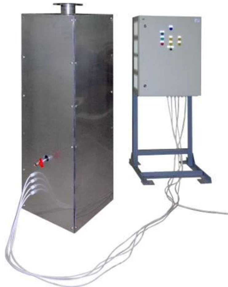
Установка для очистки порошка гафния на ЧМЗ
