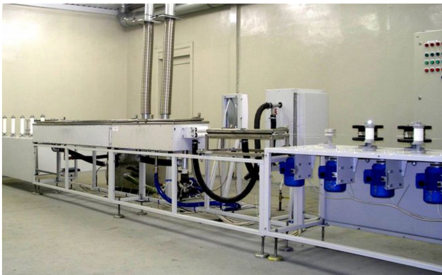
← 5-нитевая установка для очистки проволоки
