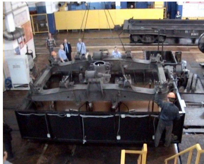
Установка для очистки тележек электровозов (самая большая в мире УЗ ванна, 19 м 3 )
