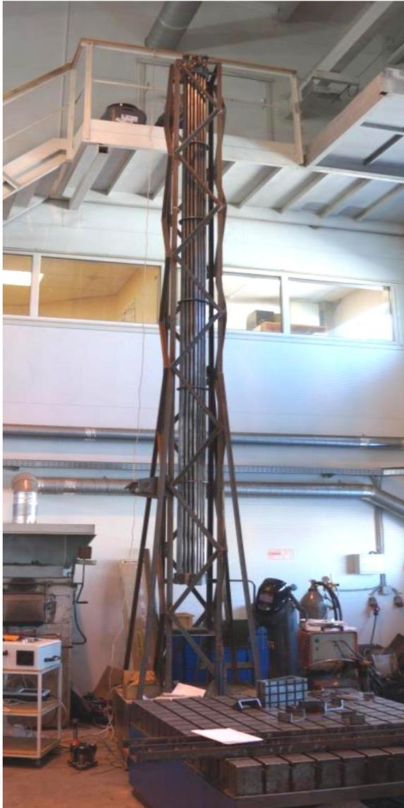
Имитационный стенд по извлечению катализатора из трубок реактора
