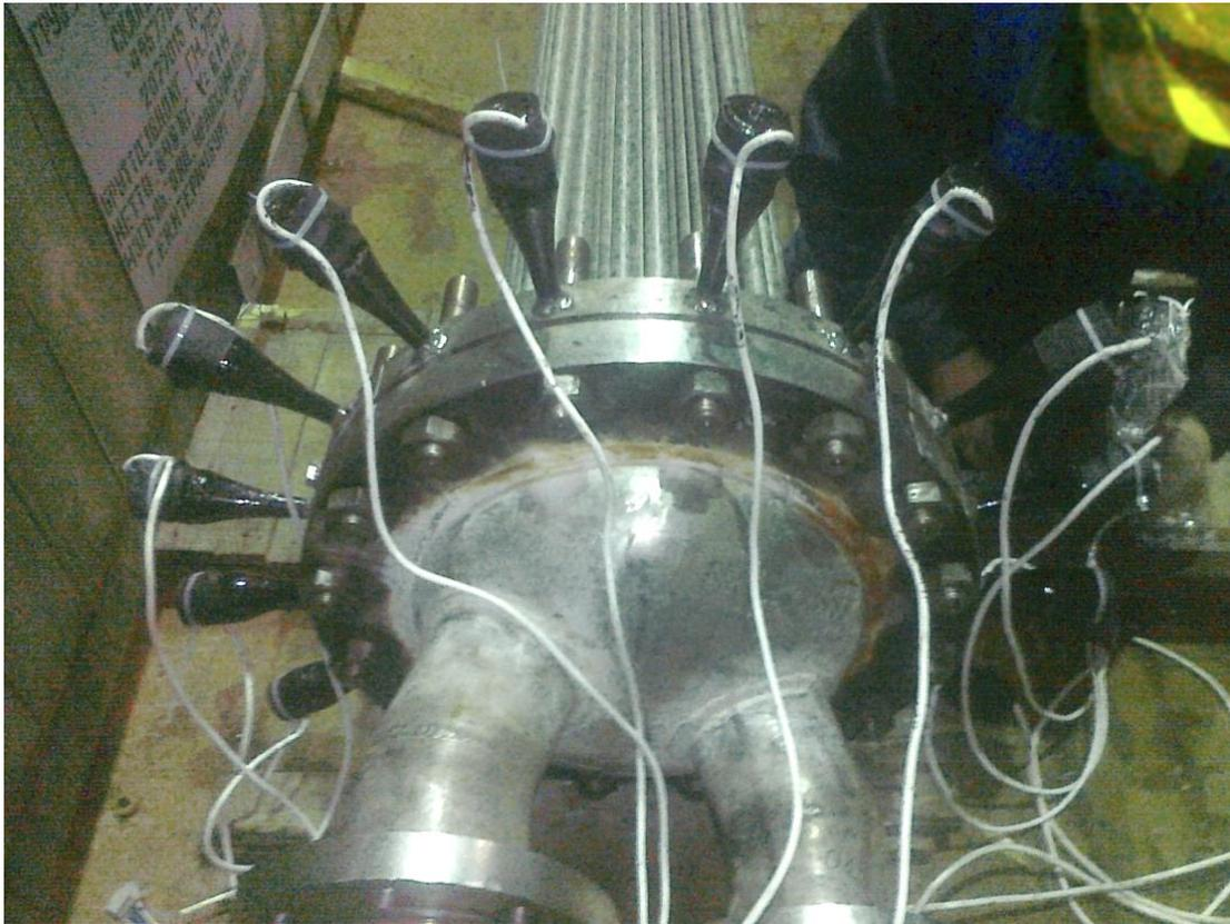
Проведение испытаний на кожухотрубном теплообменнике
