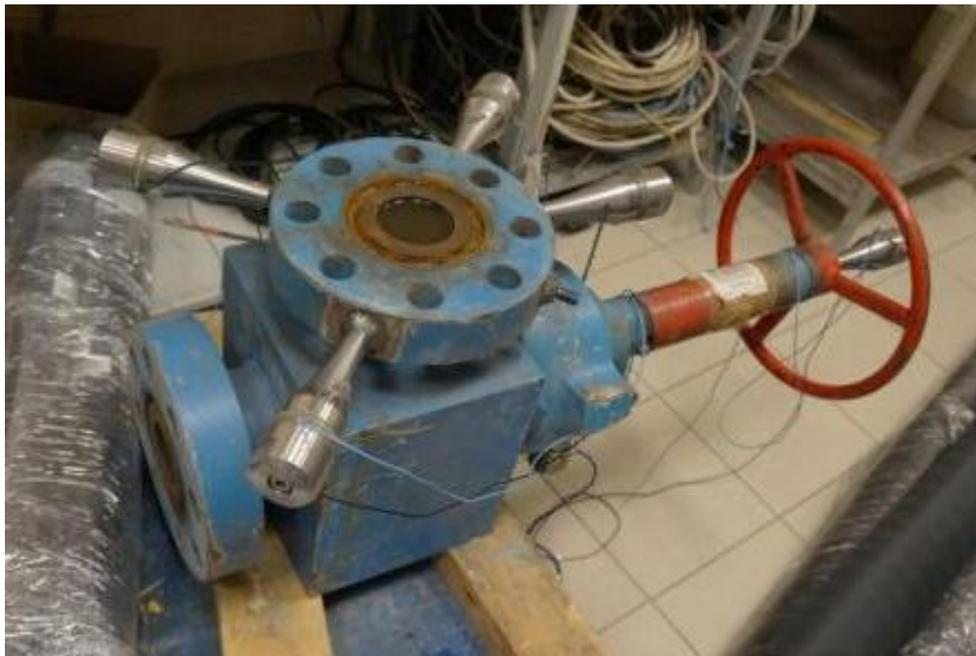
Схема размещения контактных ультразвуковых преобразователей на дроссельной заслонке
