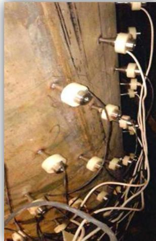
Размещение контактных ультразвуковых излучателей на наружной поверхности емкости
